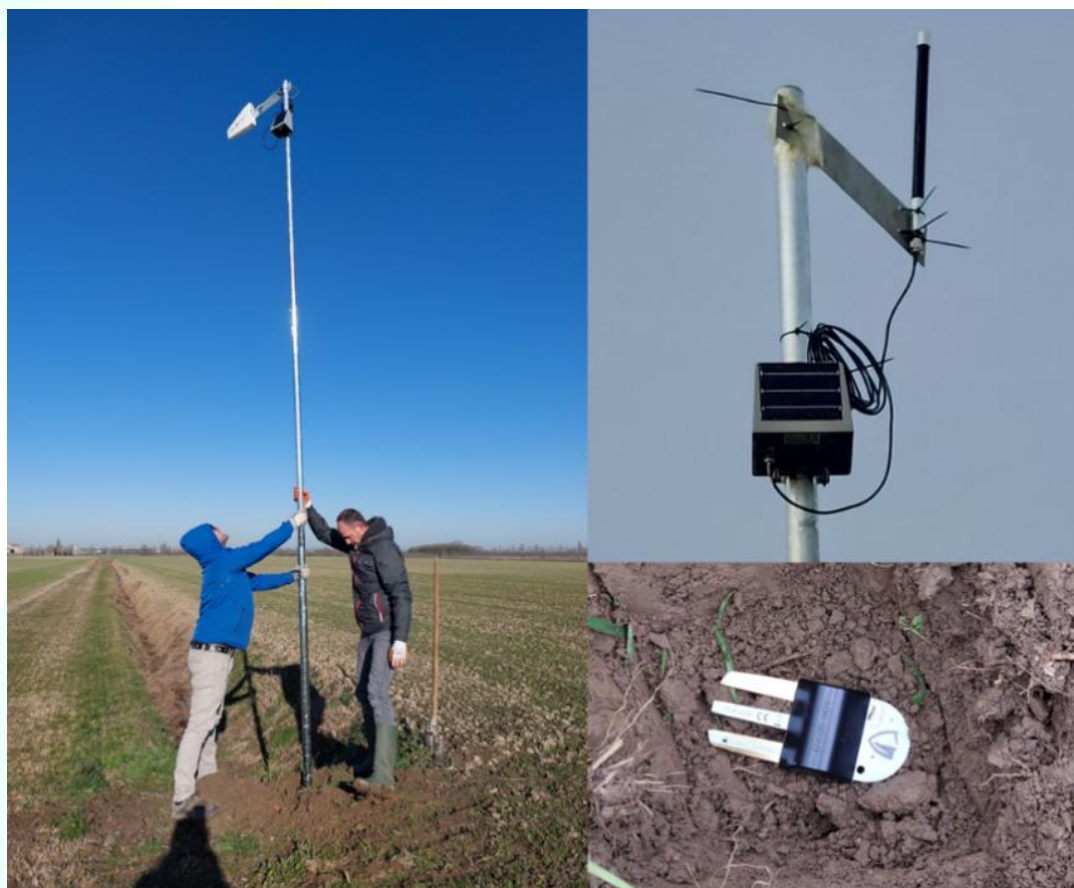
Figura 26 Posa dei sensori di temperatura e umidità del suolo, centralina che raccoglie i dati in wifi dai sensori e dettaglio di uno dei sensori installati nelle diverse tesi dei tre siti dove sono state implementate le cover crop.
