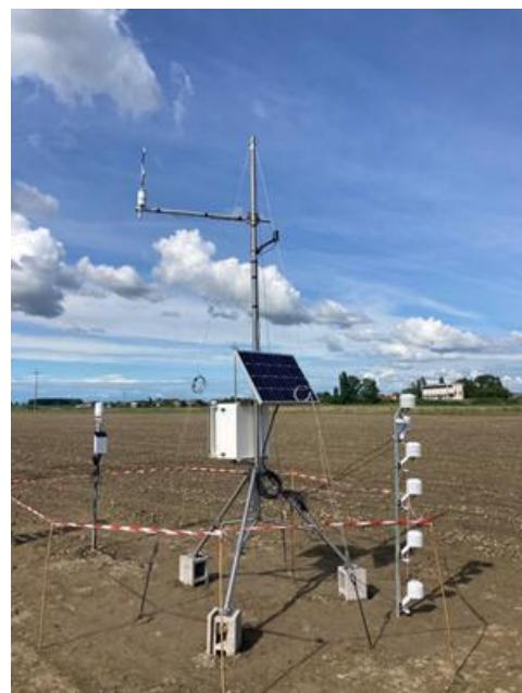
Figura 10 Stazione di misura installata presso l'Azienda "La Fagiana" per la determinazione delle principali variabili meteorologiche e dei flussi evapotraspirativi.
