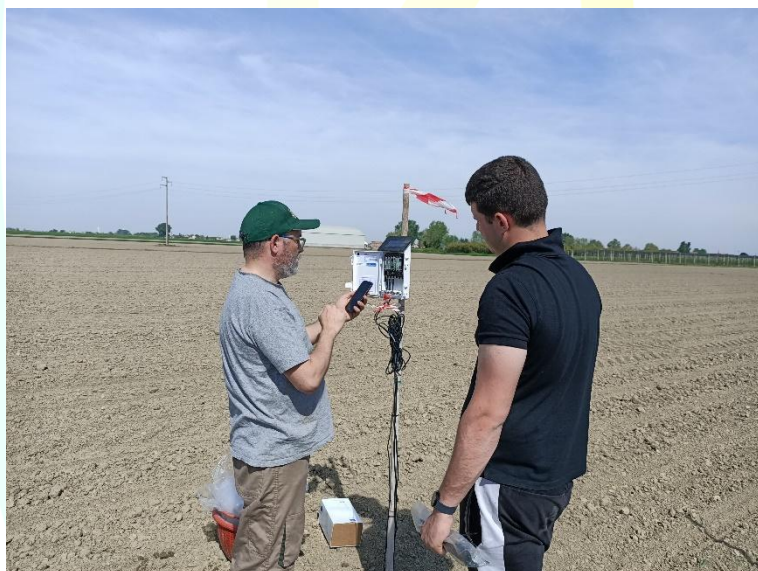
Figura 8 installazione di sonde per l'umidità del suolo nell'OFE sulla densità del mais.
