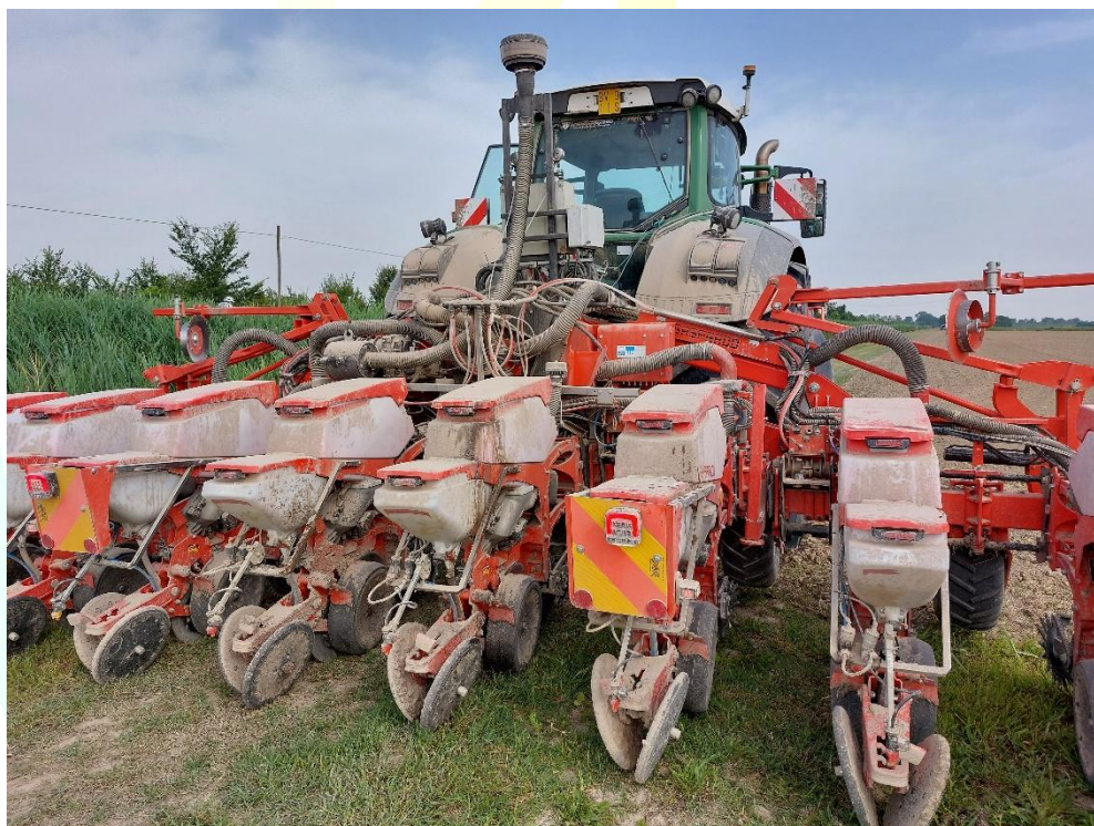
Figura 28 Seminatrice con possibilità di diserbo sulla banda utilizzata per le semine del mais nel LL.
